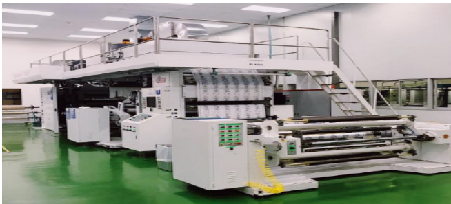
Exhibit 18: ขั้นตอนการพิมพ์ข้อความหรือลวดลายลงบนแผ่นฟิล์ม
