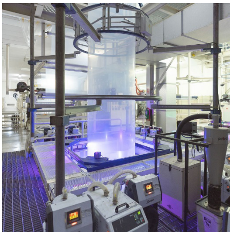
Exhibit 16: ขั้นตอนการเป่าขึ้นรูปฟิล์มสำหรับลามิเนต
