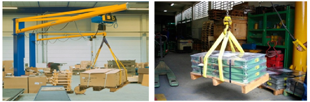
Figure 3: ตัวอย่างการใช้สลิงใยสังเคราะห์ถักหรือสลิงผ้าใบ
