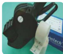
สติ๊กเกอร์และปืนยิง สำหรับติดเพื่อบ่งบอกสถานะการทำให้ปราศจากเชื้อ (Label Gun)
